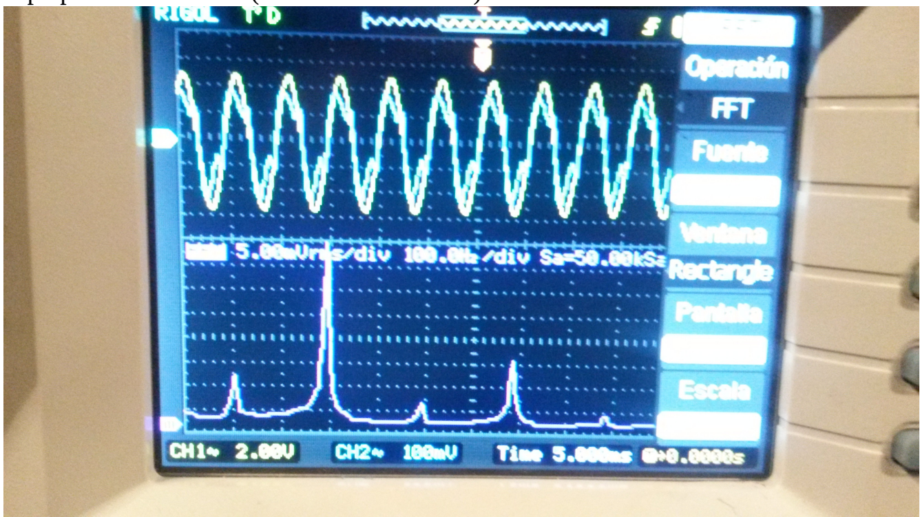
Superposición de ondas (Efecto de resonancia)
